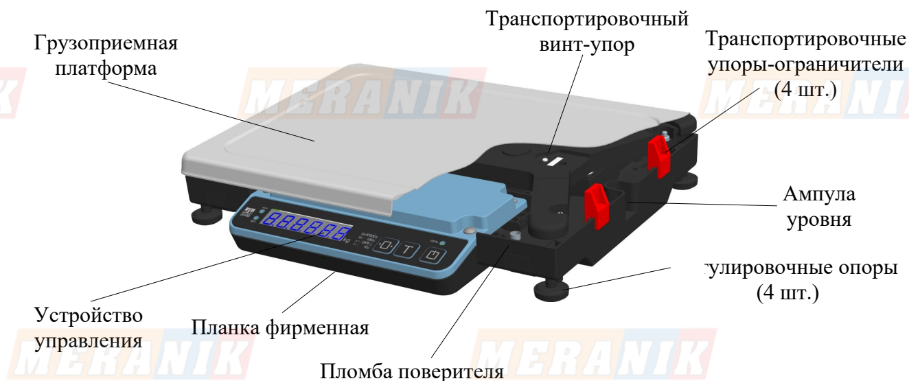
Рисунок 1 – Конструкция весов
